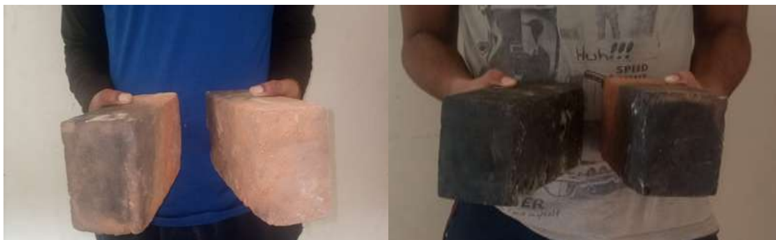
(b) 95 % clay 5 % plastic brick (95:5)(d) 85 % clay 15 % plastic brick (85:15)
