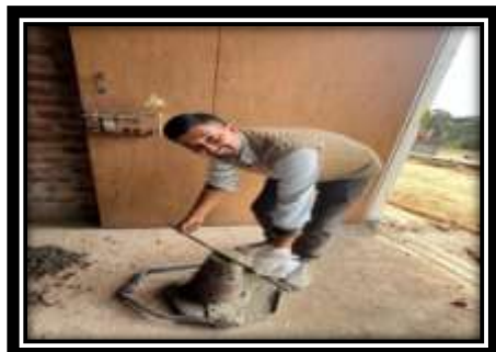
Fig.4.5 Slump cone Test
